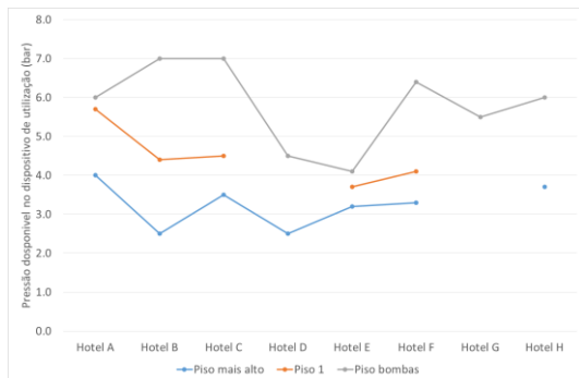
Figura 6. Pressão disponível nos dispositivos de utilização Figura 7. Perfil diário de consumo de energia nas bombas hidropressoras
